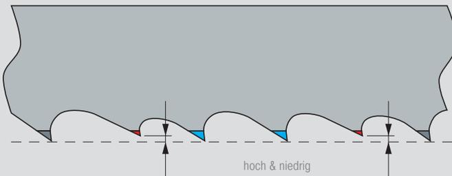
Die Differenz in den Schneidehöhen reduziert die Schnittbelastung je Zahn.
